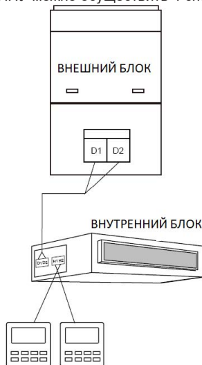
Рис. 3.4 Два ППУ контролируют один внутренний блок
